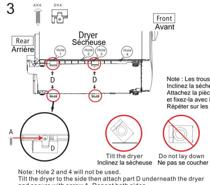
Note : Les trous 2 et 4 ne seront pas utilisés. Inclinez la sècheuse sur le côté, puis Attachez la pièce D sous la sècheuse et fixez-la avec la vis A. Répétez sur les deux côtés.
