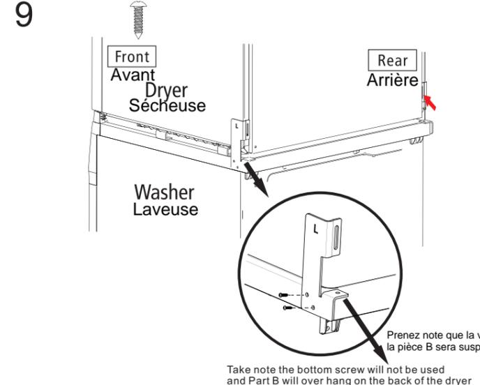
Prenez note que la vis inférieure ne sera pas utilisée et que la pièce B sera suspendue à l'arrière de la sècheuse
